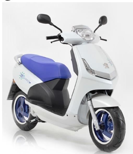
pratiche. Con "E-Vivacity" è cosa fatta grazie alla riduzione del volume delle batterie che consente di ottenere una riduzione del peso pari al 60% rispetto ai modelli della precedente generazione. "E-Vivacity", riesce a mantenere una sagoma compatta (misura meno di 2 metri) e, offre lo stesso volume di carico utile del suo fratellino in versione termica, cioè 35 litri. Grazie alla possibilità di alloggiare due caschi nei suoi 2 vani (uno sotto la sella e l'altro nello scudo
